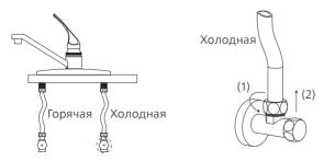
b. Наденьте гайку трехходового шарового крана на полиэтиленовую трубу 3/8" (9,525 мм) и вставьте трубу в отверстие трехходового шарового крана.
