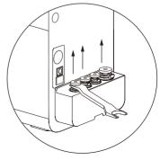
b. Conecte la entrada de agua y la válvula de bola de tres vías.
