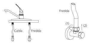
b. Far scorrere il dado della valvola a sfera a tre vie nel tubo 3/8" PE; e inserire il tubo nell'apertura della valvola a sfera a tre vie. Serrare il dado con una chiave.
