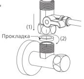
d. Соедините шланг холодной воды с трехходовым шаровым краном и плотно закрутите гаечным ключом.
