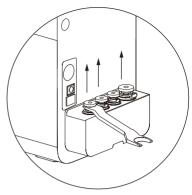
b. Соедините впускное отверстие для воды и трехходовой шаровой кран.
