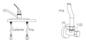
b. Deslice la tuerca de la válvula de bola de tres vías en la tubería de PE de 3/8" e inserte la tubería en la abertura de la válvula de bola de tres vías. Apriete la tuerca con una llave.
